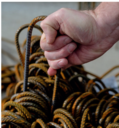
Aus diesen Stahlbauteilen werden Bewehrungskörbe geflochten, in die Schalung eingesetzt und in Beton eingegossen. Das Resultat: Stahlbeton hoher Festigkeit.
